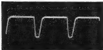
Bild 2. Negative Impulse an der Katode der Abstimm-Verstärkerröhre im Normal-Betriebszustand
