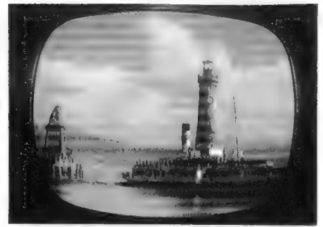
Bild 6. Oszillator nach oben verstimmt. Bild zeigt Tonstreifen und Plastik
