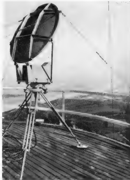
Oben und rechts: Bild 2. Fernsrichtfunkstrecke auf der 70 m hohen Plattform des Antennenmastes Kahlenberg bei Wien
