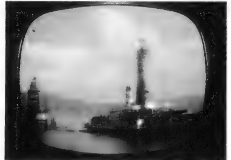
Bild 7. Oszillator nach unten verstimmt. Hohe Frequenzen fehlen, Bild ist unscharf
